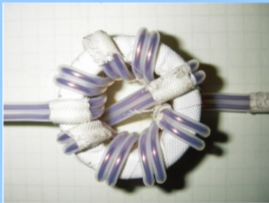
2-Bobiner la ligne
