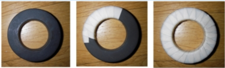
1-Protéger les arêtes vives de la ferrite
