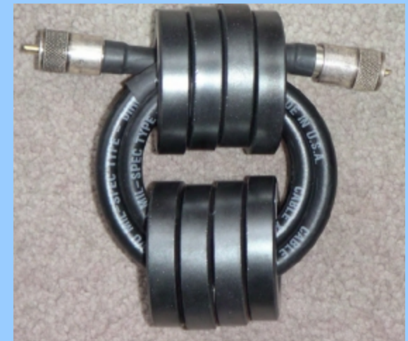
RG213 & tores mix 43 Impédance 1K de 1.8à18MHz
